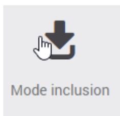
Lancez la trame d'appairage du capteur (généralement un bouton d'appairage sur les produits basiques et un outil ou un écran de paramétrage pour les produits avec plusieurs EEP) et attendez que la passerelle le détecte (quelques secondes tout au plus). (Relancez plusieurs fois la trame si l'appareil n'est pas détecté).
