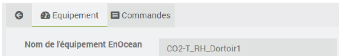
L'alias est très utile pour identifier ultérieurement les sondes. Essayez d'avoir une dénomination méthodique du type : Ville, Bâtiment, étage, pièce, type de sonde (ex : Boulogne B,123 Bellevue, Bâtiment A, RDC, B126, QAI)
