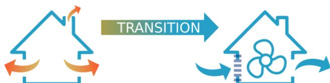
Un bâtiment bien isolé perd principalement des calories par le **rejet d'air chaud l'hiver ou d'air frais l'été lié à la ventilation**. La consommation de chauffage et de climatisation devient alors principalement liée au débit d'air renouvelé.
